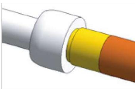
El Adaptador Metálico que es insertado de manera predeterminada es macho y campana, para alternar entre las opciones disponibles, seleccione el Adaptador y en la casilla "Construction" podrá variar las opciones.
